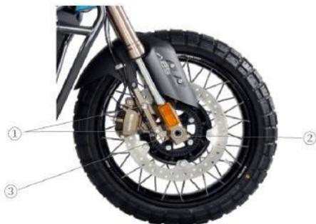
Par de apriete del eje delantero: 65 Nm
