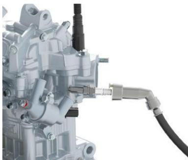
⚠ **PELIGRO** Cuando compruebe la chispa en la bujía, no sitúe la bujía cerca de su orificio ya que la mezcla de aire-gasolina puede salir por el orificio, prenderse con la chispa y producir un incendio.
