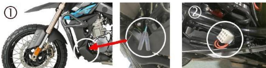
La motocicleta cuenta de serie con un conector situado bajo el depósito de gasolina por el lado izquierdo como muestra la Imagen 1. El conector es del tipo bala hembra y sólo proporciona alimentación cuando el motor está en marcha, pudiendo conectarse faros auxiliares sin dañar los circuitos eléctricos originales.
