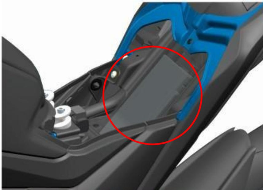
La batería se encuentra debajo del asiento del piloto. Se trata de una batería sin mantenimiento. Para su primer uso, conecte los bornes positivo y negativo y monte el tirante de goma.
