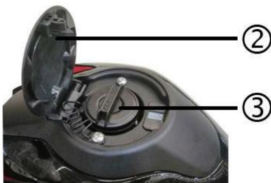
El depósito de gasolina se encuentra delante del asiento. Para repostar gasolina deberá abrir la tapa de acceso al tapón. Asegúrese de que el motor esté parado, y pulse el botón del depósito de gasolina (1), la tapa (2) se abrirá automáticamente, gire el tapón (3) del depósito de gasolina en sentido antihorario. Para cerrar el depósito, siga el orden opuesto al descrito.
