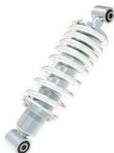
El muelle del amortiguador trasero se ajusta según las necesidades de conducción, la carga y el estado de la carretera. Para ello solo necesita detener la motocicleta con el caballete lateral. Ajuste la precarga del muelle a la posición deseada. La rigidez disminuirá cuando lo ajustemos hacia abajo y aumentará cuando la ajustemos hacia arriba.
