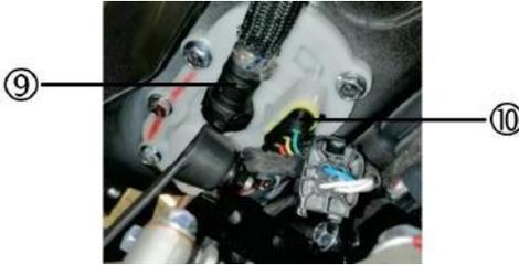
Retire el tubo de gasolina (con presión) de la bomba (9) y el conector de la bomba de gasolina (10).
